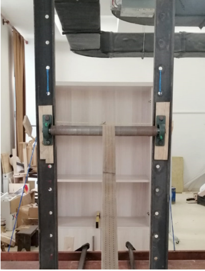
Şekil 3. Yükseklik ayarlı güç aktarım sistemi
