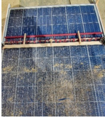
Şekil 13. Hava Üfleyci Sisteme Sahip Susuz Temizleme Robotu (Habib vd., 2021)
