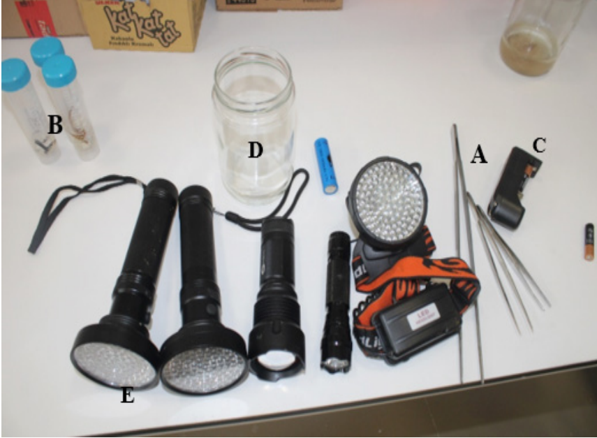
Şekil 3.4. Örneklerin toplanmasında kullanılan 25 cm'lik pens (A), Örneklerin saklandığı 50 ml'lik plastik tüp (B), UV lamba pillerini şarj eden Ataba marka şarj aleti (C), 200 ml'lik cam kavanoz (D), UV lamba (E)
