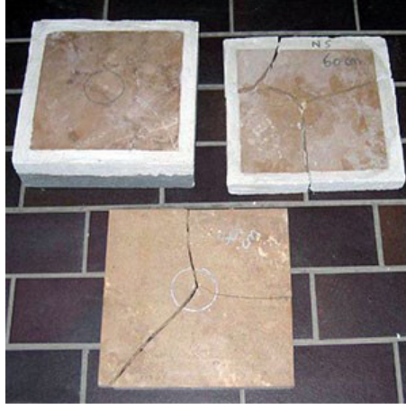
Şekil 4. Bir Darbe Testi Sırasında Desteğin Etkisi (Döşeme Harcı, Stabilize Kum Ve Desteksiz) (URL 3, 2023)
