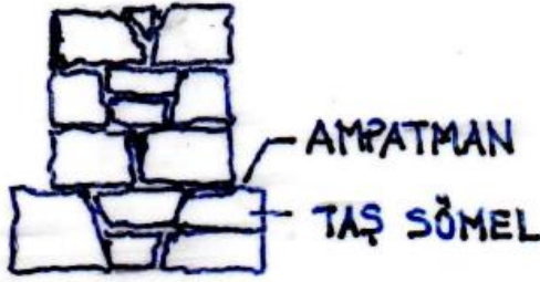
Şekil 5. Taş temel kesitinde sömel ve ampırtman
