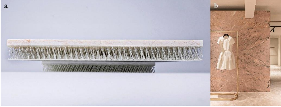
Şekil 15. Solda fiberglass bal peteği dolgu katmanı ile lamine edilmiş doğal taş kompozit malzeme(a) Sağda lamine kompozit uygulanmış iç mekan duvar kaplama örneği(b)(URL-14).
