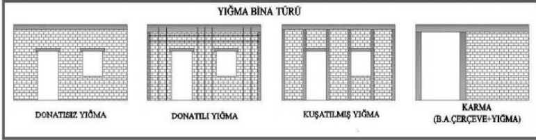
Şekil 10: Yığma Bina Sistem Krokileri (Çevre ve Şehircilik Bakanlığı, 2020)
