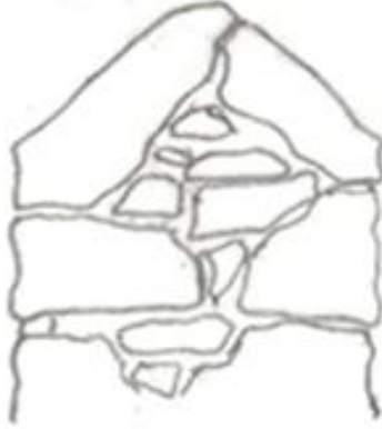
Őekil 41. Moloztař duvar iin harpuřta yapımı
