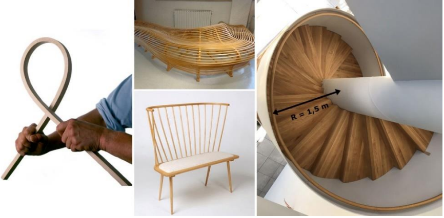
Şekil 5. Solda bükülebilir ahşap (URL-6), Ortada ve sağda bükülebilir ahşap ile üretilmiş tasarımlar (URL-7, URL-8)
