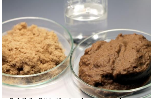
Şekil 9. Öğütülmüş ahşap ve su karışımı ağdalı süspansiyon (Fraunhofer Institutefor Wood Research, 2019)
