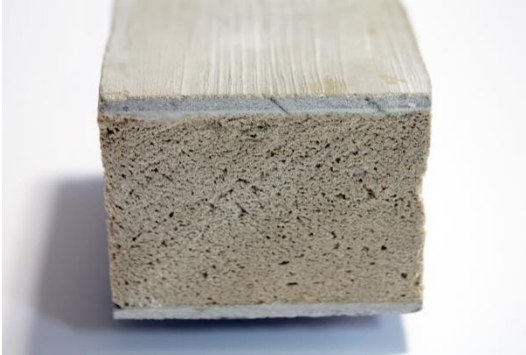
Şekil 10. Tekstil takviyeli beton yüzeye sahip ahşap köpük kompozit panel (URL-10)
