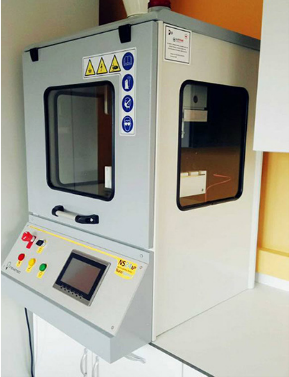
Şekil 2.1: Üretimde kullanılan elektroğirme cihazı (Inovenso marka NS24XPro model elektroğirme cihazı)
