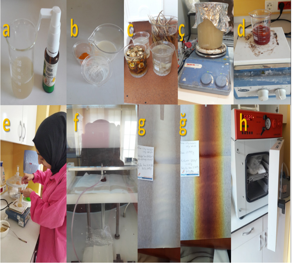
Şekil 2.2 : Doku iskelelerinin elektroğirme tekniği ile üretim aşamaları; (a) Çözelti hazırlama, (b) hammadde tartımı, (c) maddelerden yağ giderimi, (ç) polimer çözeltisi hazırlama, (d) kompozit çözeltisi hazırlama, (e) hazırlanan çözeltinin şırıngaya çekimi, (f) elektroğirme ile doku iskelesi üretimi, (g) polimer doku iskeleleri, (ğ) kompozit doku iskeleleri ve (h) vakum etüvünde üretilen doku iskelesi membranlarının kurutulması
