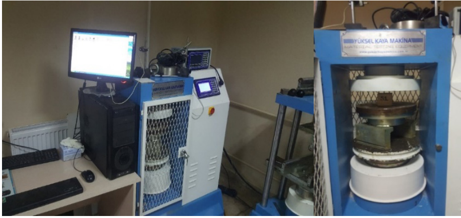
Şekil 3. Basınç Dayanım Deneysel Düzenegi
