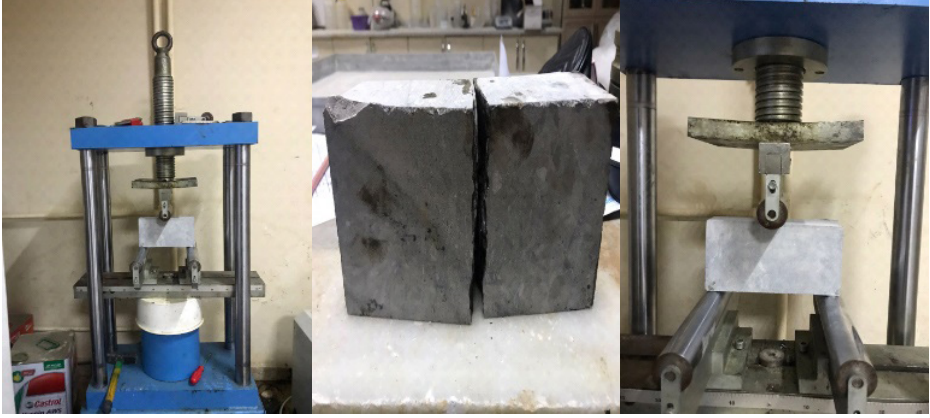
Şekil 4. Eğilme Dayanımı Deneyi Düzeneği
