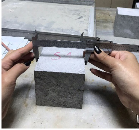
Şekil 6. Birim Ağırlık Deneyi Numunesi
