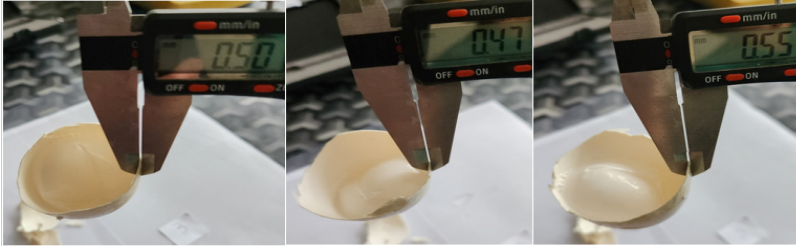
Şekil 18. Kaz yumurtasının küt uç kabuk kalınlığının ölçümü
