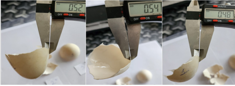
Şekil 17. Kaz yumurtasının sivri uç kabuk kalınlığı ölçümü
